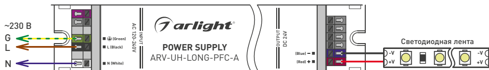
Рис.1. Схема подключения блока питания напрямую к светодиодной ленте
