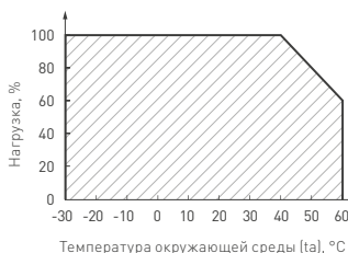
Рис. 4. Максимальная допустимая нагрузка, % от мощности источника
