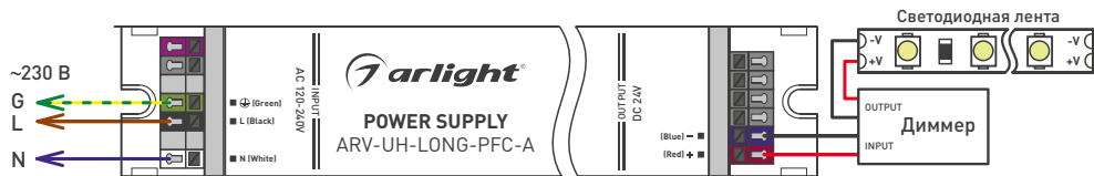
Рис. 2. Схема подключения блока питания к светодиодной ленте через диммер
