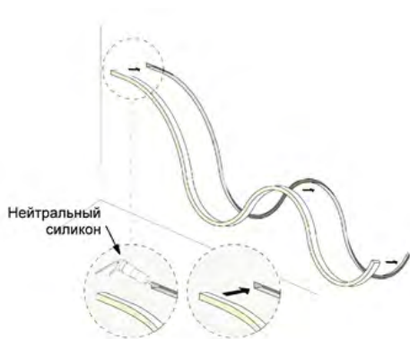
КРИВОЛИНЕЙНАЯ УСТАНОВКА В ПАЗ
